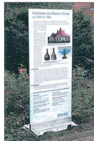
Die Glasstelen sind als Verbund-sicherheitsglas ausgeführt. Auf der Rückseite der vorderen Platte wurden Text und Motive im Siebdruck mit keramischen Glasfarben aufgebracht.
